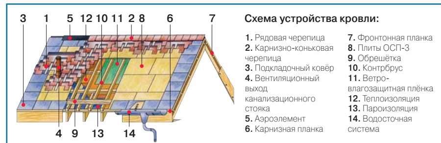
20. При монтаже коньково-карнизной черепицы делают отступ от перегиба капельника на 0,5–1 см
