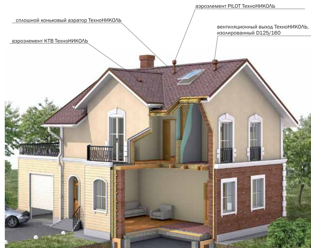
Рис. 16. Схема устройства вентиляции подкровельного пространства
