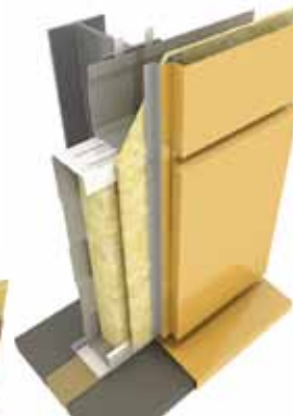
Облицовка фасадными кассетами
