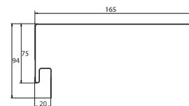
**J-профиль широкий (наличник)** предназначен для закрытия рядового сайдинга сбоку. J-профиль широкий служит для отделки дверных и оконных проемов. J-профиль может быть использован в качестве наличника, финишного профиля, а также при отделке наружных и внутренних углов.
