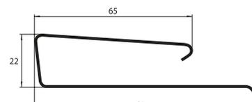
**Наружный и внутренний углы** устанавливаются для стыковки панелей сайдинга на углах. Наружный угол можно использовать при обрамлении окон и торца крыши. Внутренний угол можно применять на стыке части выступающей крыши с вертикальной стеной.
