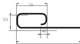
**H-профиль соединительный** служит для соединения панелей сайдинга, если длина стены превышает длину панели. H-профиль также используется как элемент дизайна.
