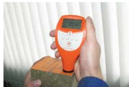
Проверка толщины покрытия.
