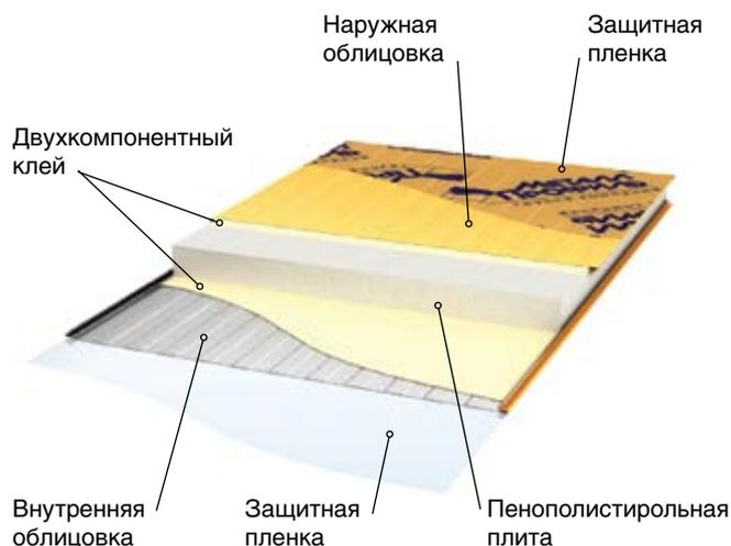
Для обеспечения прочного соединения облицовки и теплоизоляции в ТСП Металл Профиль используется высококачественный двухкомпонентный клей на полиуретановой основе европейских производителей. Композиция клея специально разработана таким образом, чтобы обеспечить высокие прочностные свойства соединения сердечника с металлическими облицовками в течение всего срока эксплуатации панелей.
