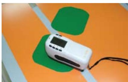
Проверка разнооттеночности покрытия.
