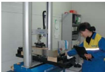
Испытание на сдвиг-срез.
